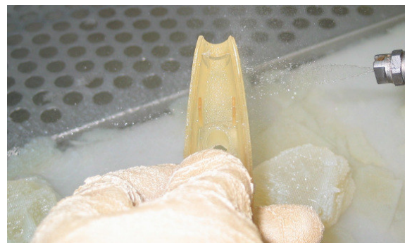
Entfernen des Stützmaterials
